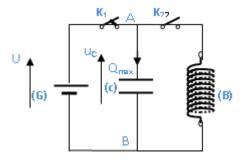
2- Les armatures de ce condensateur chargé sont reliées à une bobine d'inductance L de résistance négligeable. A un instant t=0s, pris comme origine des temps on ferme l'interrupteur K2 et on ouvre K1 (Voir figure).
