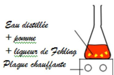
**Observations :** Après un chauffage modéré, la solution bleue et limpide se trouble (apparition d'un précipité rouge brique).
