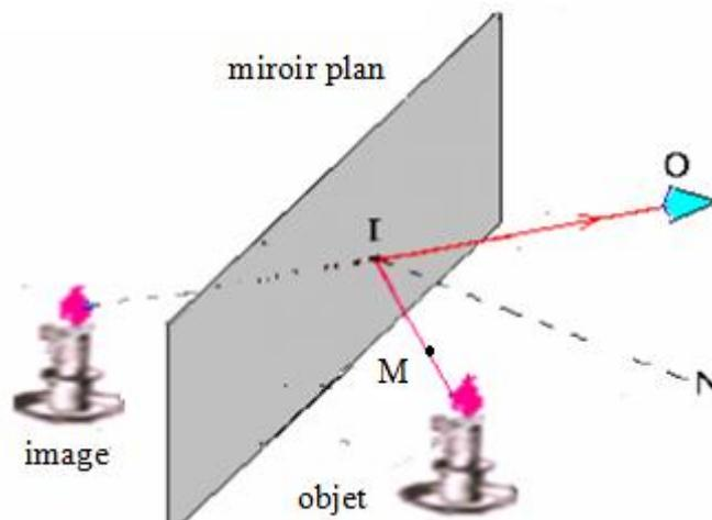
On trace la ligne liant les positions de l'objet et celle de l'image puis on mesure la distance (objet –miroir) puis celle (image –miroir).
