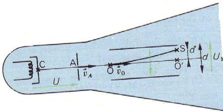
3) Les électrons pénètrent avec une vitesse  $V_O = V_A$ , entre les plaques de déviation verticale, en un point O situé à égale distance de chacune d'elles. Lorsque la tension  $U_1 = 500V$  est appliquée à ces plaques distantes de  $d = 2cm$ , les électrons sortent de l'espace champ en un point S tel que  $O'S = d' = 0,6cm$ .
