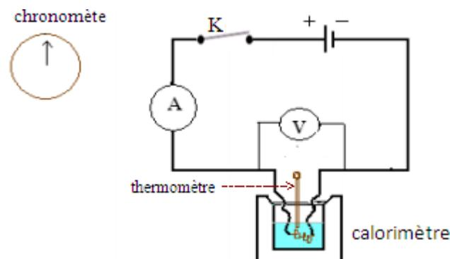
On mesure tout la température initiale de l'eau froide dans le calorimètre et on introduit la résistance chauffante dans le calorimètre puis on ferme l'interrupteur tout en déclanchant le chronomètre. Après une durée  $\Delta t$  on note la température finale tout en arrêtant le chronomètre.
