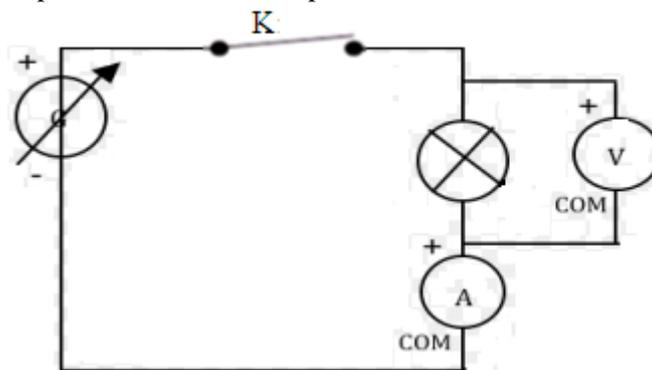
On fait varier la tension du générateur jusqu'à ce que la lampe s'allume ceci se réalise lorsque la tension aux bornes de la lampe prend la valeur  $U=24V$  et l'ampèremètre indique l'intensité  $I=0,25A$  .
