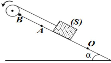
**تمرين 1** نلف حول مجرى بكرة، شعاعه  $r=10\text{cm}$  و عزم قصورها بالنسبة لمحور أفقي ثابت ( $\Delta$ ) يمر بمركزها  $J_{\Delta}=4.10^{-2}\text{kg.m}^2$ , خيطا ثبت في طرفه جسم صلب ( $S$ ) كتلته  $m=500\text{g}$ . يحدث بواسطة محرك دوران البكرة، فينطلق ( $S$ ) بدون سرعة بدنية من النقطة  $O$  منزلقا نحو الأعلى حسب الخط الأكبر ميلا للمستوى ( $\pi$ ) الذي يكون زاوية  $\alpha=30^\circ$  مع المستوى الأفقي.
