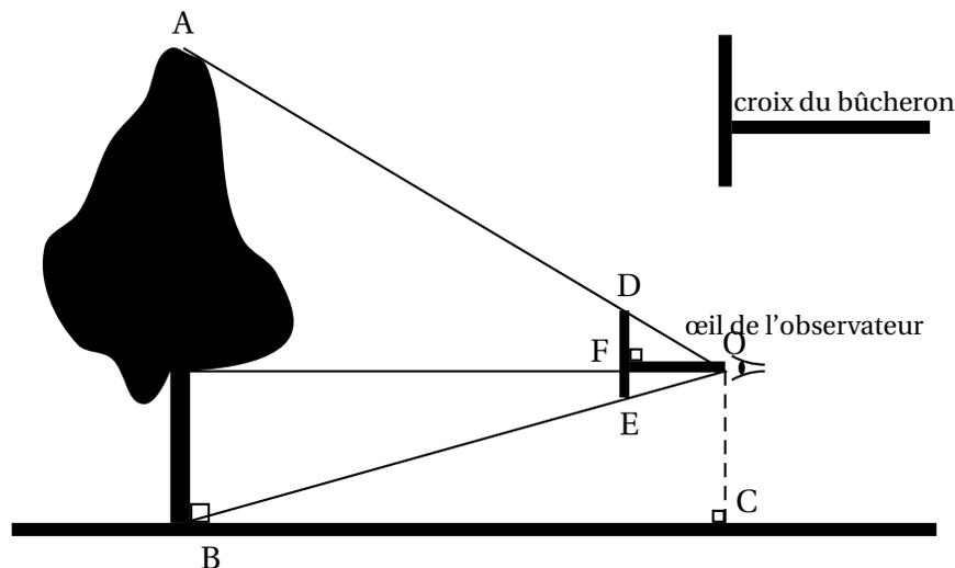
Il place la croix de sorte que O, D et A d'une part et O, E et B d'autre part soient alignés.
