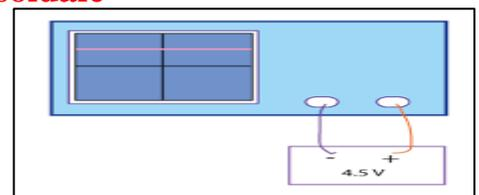
La tension délivrée par une pile est **continue est constante** : elle impose un seul sens pour le courant, dont l'intensité est **constante** au cours du temps
