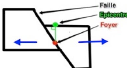
22 - Les failles résultent de la cassure des roches du sol par des forces très importantes et bien supérieures à la résistance des roches. Ainsi, le schéma (*titre: formation d'une faille*) doit permettre de visualiser ces fameuses forces. Dans l'exemple ci contre, les forces agissant sur la roche sont représentées par des flèches bleues.
