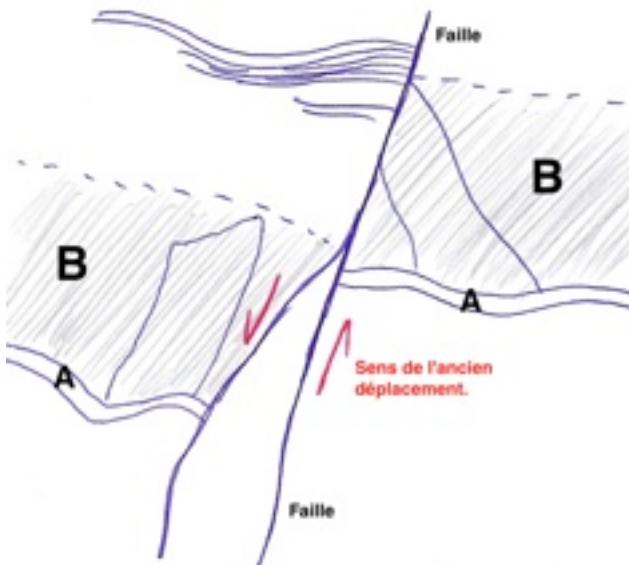
Sur ce schéma, on a représenté, de part et d'autre de la faille, en forme de «Y» inversé, le décalage des couches de roches. La fine strate blanche, A, est ainsi décalée, tout comme la couche B, qui la surplombe, et contient de grandes pierres plates.
