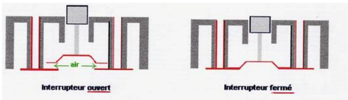
**Principe de fonctionnement :** Lorsqu'on ouvre un interrupteur, on introduit dans le circuit de l'air qui est un isolant. Le courant ne peut donc plus circuler.
