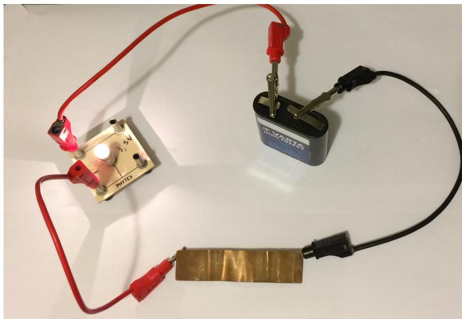
Il suffit d'observer si la lampe s'allume ou si elle reste éteinte pour déduire la nature du matériau testé.
