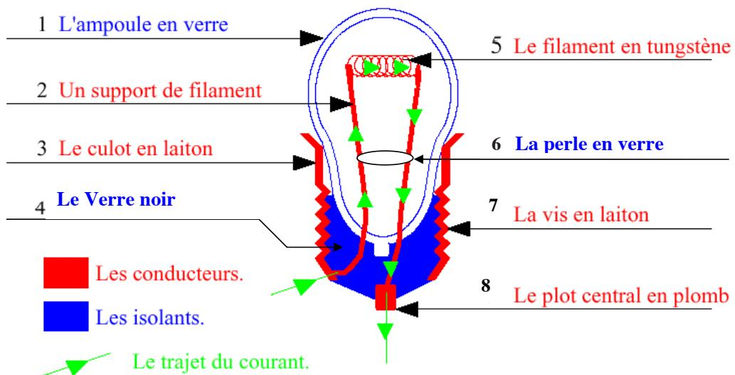
**Conclusion :** Une lampe est constituée d'une chaîne conductrice : Plot, tige, filament, culot. L'ampoule protège le filament des chocs, de la poussière. (Elle évite de poser sa main dessus et de se brûler.) Mais surtout, l'ampoule empêche le filament d'être en contact avec le gaz dioxygène de l'air.
