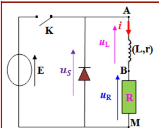
عند فتح الدارة ينتج فرط توتر في الدارة ، وتظهر معه شرارة كهربائية على مستوى قاطع التيار لتبقي شدة التيار متصلة ، وقد يؤدي إلى إتلاف بعض أجزاء الدارة . ولتفادي ذلك ، نضيف للدارة صماما ذي وصلة نسميه في هذا التركيب "صمام العجلة الحرة" .
