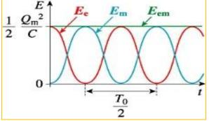
. تكون الطاقة الكلية لدارة مثالية LC ثابتة وتساوي الطاقة البدئية المخزونة في المكثف  $\Phi$
