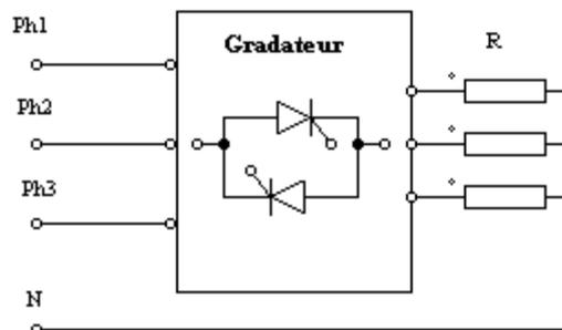
**Figure 8 :** Gradateur triphasé à thyristor
