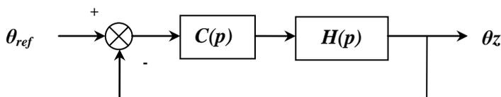
**Figure 10** : boucle de régulation de température avec correction
