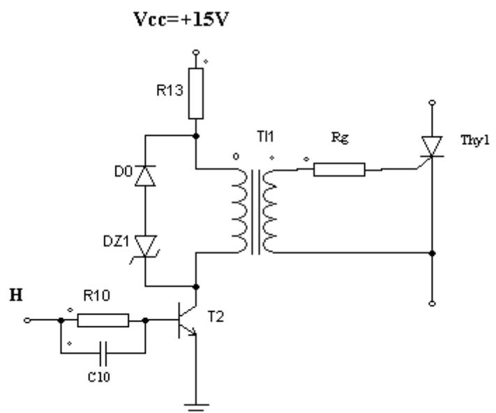
**Figure 16:** Montage d'attaque du Thyristor
