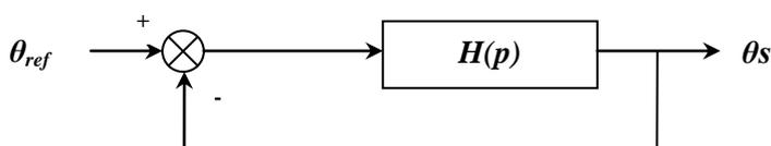
**Figure 9** : boucle de régulation de température
