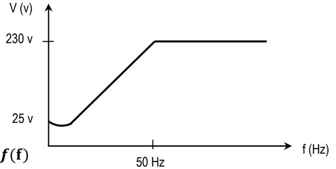
**Figure 6 :** loi de commande de l'onduleur  $V = f(f)$
