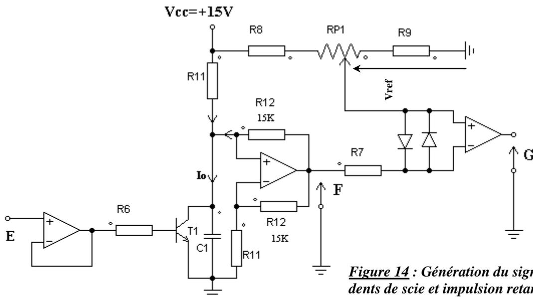
**Figure 14 :** Génération du signal en dents de scie et impulsion retardée
