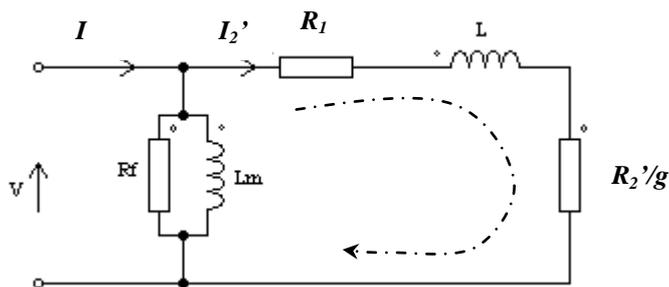
**Figure 3 :** Schéma monophasé simplifié du Moteur  $M_1$
