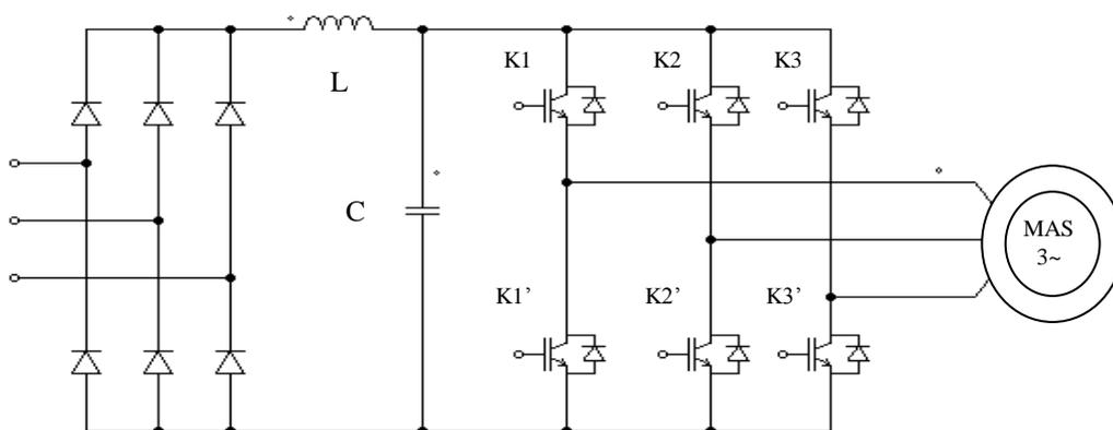
**Figure 4 : Alimentation du Moteur M<sub>1</sub>**
