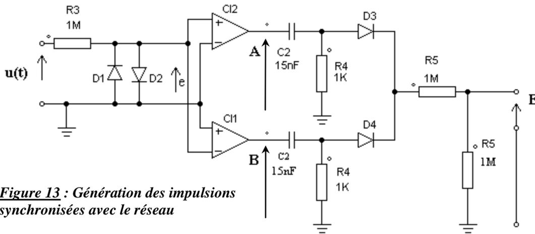
**Figure 13 :** Génération des impulsions synchronisées avec le réseau
