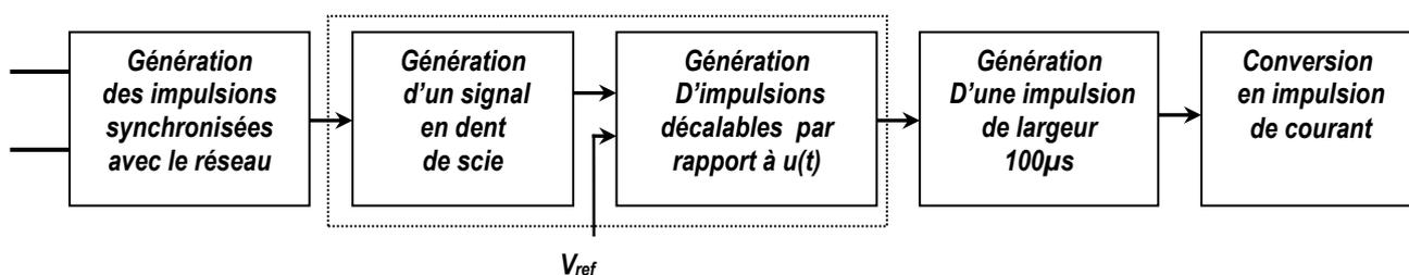
**Figure 12 :** Schéma bloc des étages du montage
