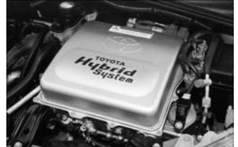
Figure 11 Convertisseur DC/DC + Onduleurs CV7 et CV9
