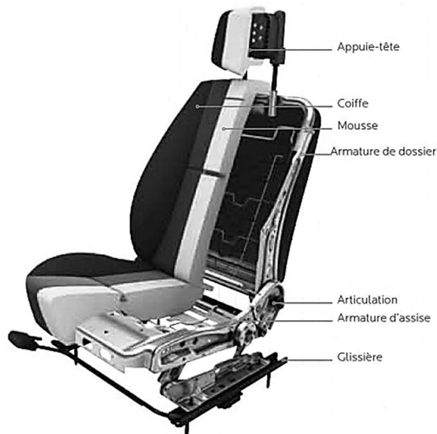
Figure 2 - Composition d'un siège automobile
