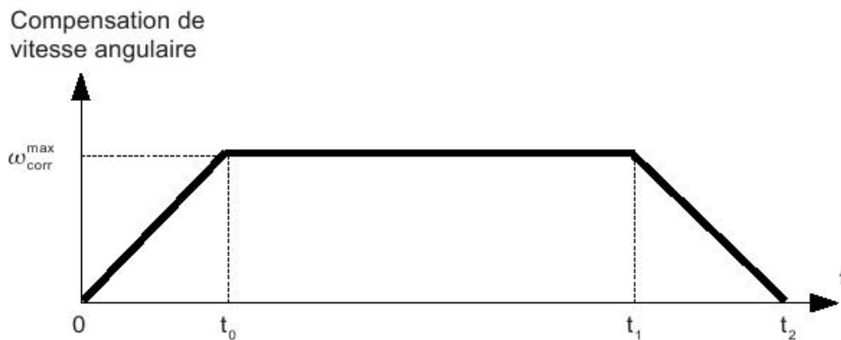
Figure 13 : loi de vitesse angulaire de compensation de tangage en fonction du temps.
