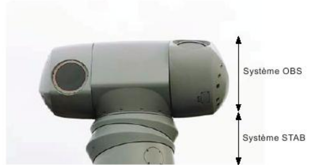
Figure 5 : identification des systèmes STAB et OBS, avec têtes sensorielles orientées différemment.
