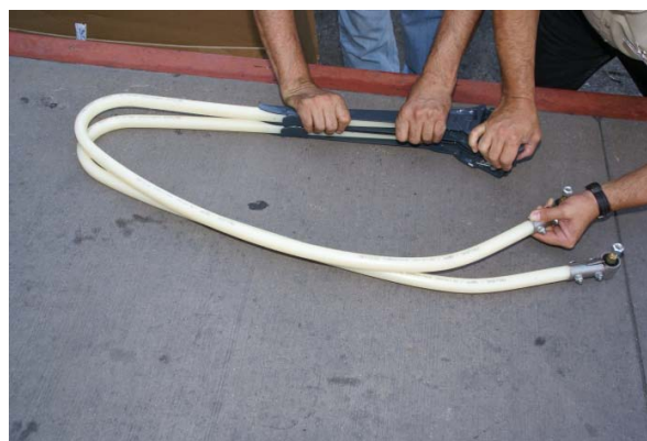
Figure 2.6 : Déformation des batteurs
