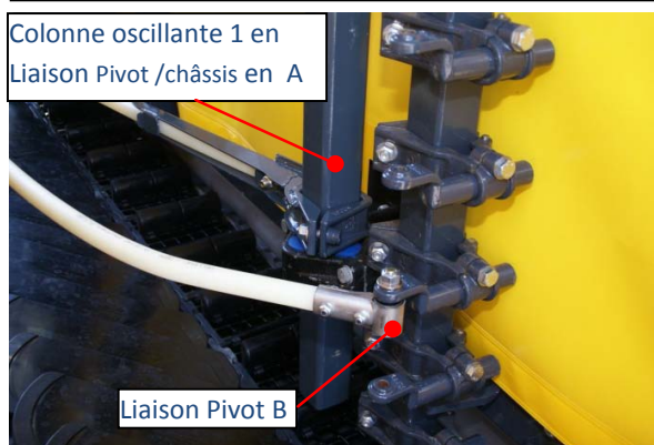
Figure 2.2 : Batteurs : photo prise batteurs en mouvement à vide
