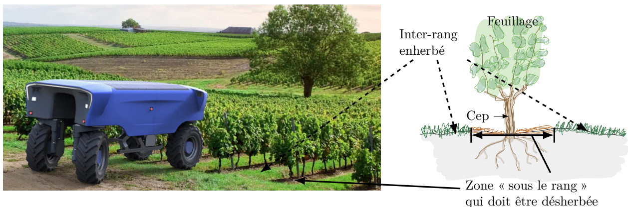
Figure 1 Robot Bakus (vue de gauche) sans outil dans une vigne avec inter-rang enherbé et espace sous le rang désherbé mécaniquement. Morphologie d'un plan de vigne (vue de droite) et vocabulaire associé.
