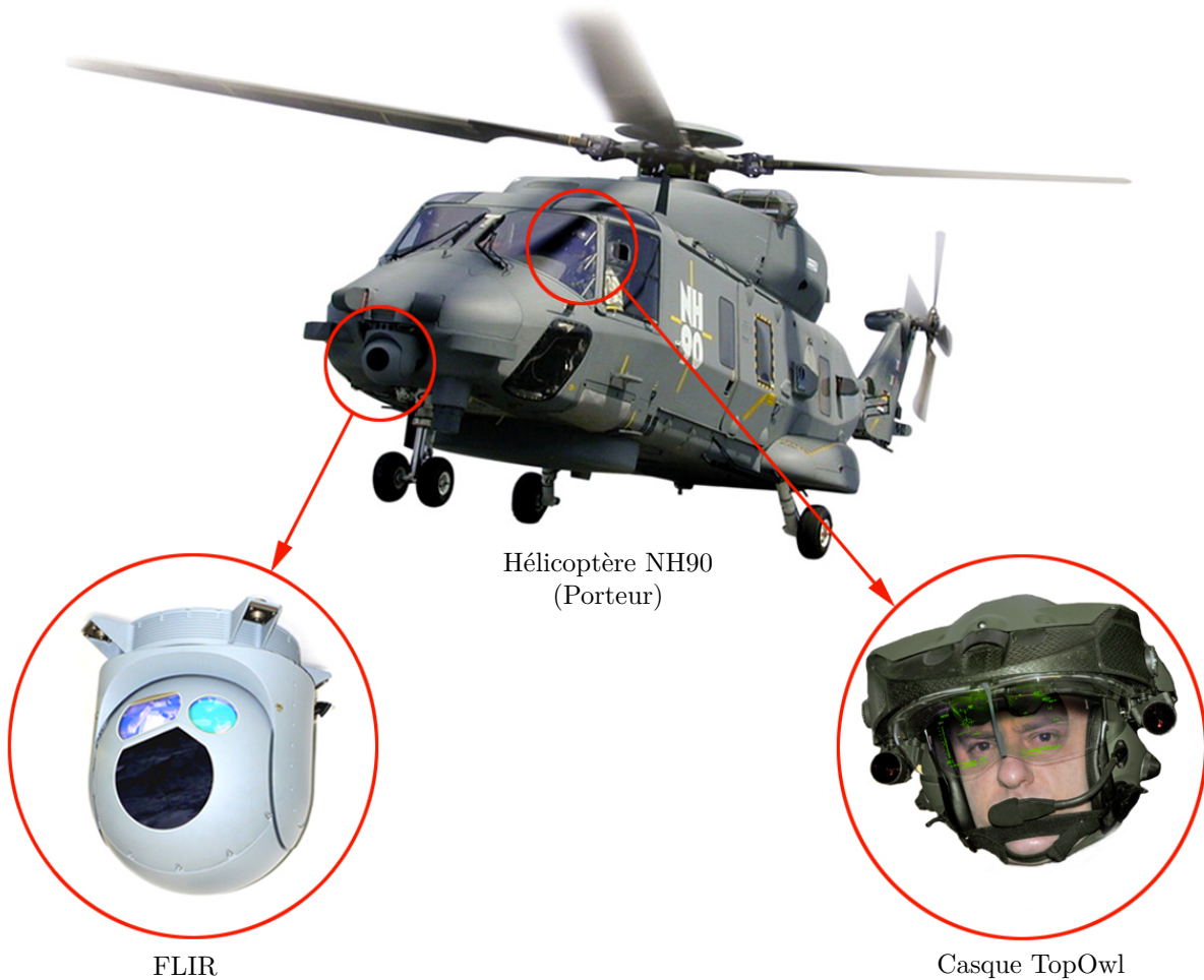
Figure 1 Hélicoptère NH90 équipé du système de vision en réalité augmentée
