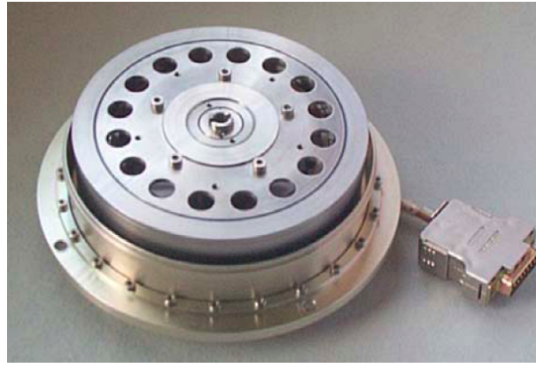
Figure 6 Roue de réaction (carter ouvert)
