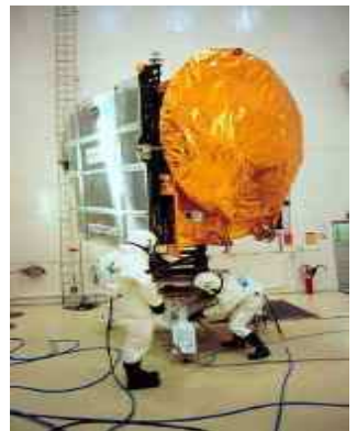
Télécom 2 en cours d'essais (configuration stockée)
