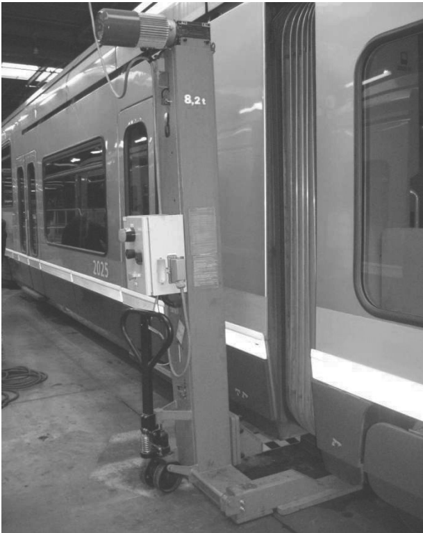
Photo 3 : Mise en place d'une colonne
