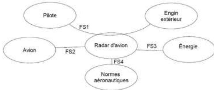
FS1 : permettre au pilote de connaître la position des engins extérieurs
