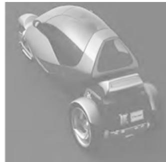
Le déplacement du centre de gravité qui en résulte lui confère une grande stabilité malgré une faible largeur du véhicule (légèrement inférieure à 1 m, contre 60 à 75 cm pour une moto, et 1,5 m pour une petite voiture).
