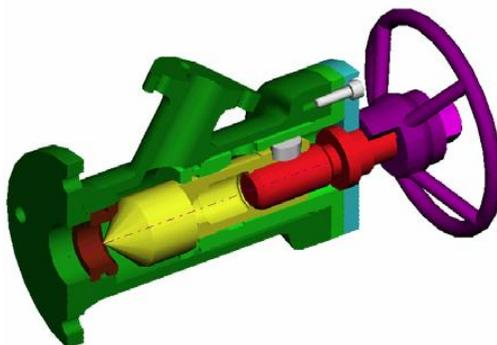
Le volant 2 entraîne la vis de commande (liaison complète) en rotation par rapport au corps 1 (liaison pivot), la vis de commande entraîne par l'intermédiaire d'une liaison hélicoïdale le pointeau 3, le pointeau est en liaison glissière par rapport au corps.
