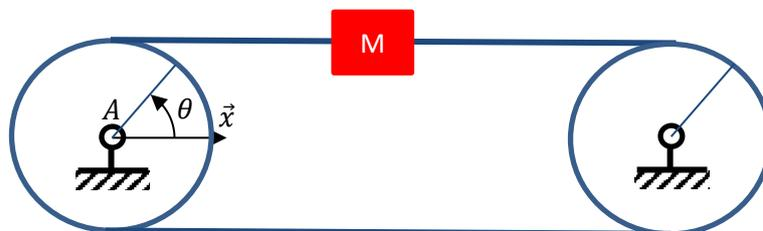
Pour déterminer la loi de mouvement de la masse, on détermine la masse équivalente de l'ensemble puis on détermine sa loi de mouvement en appliquant le TEC. On peut alors en plus obtenir la loi de mouvement des poulies avec la relation  $V = R\dot{\theta}$ .
