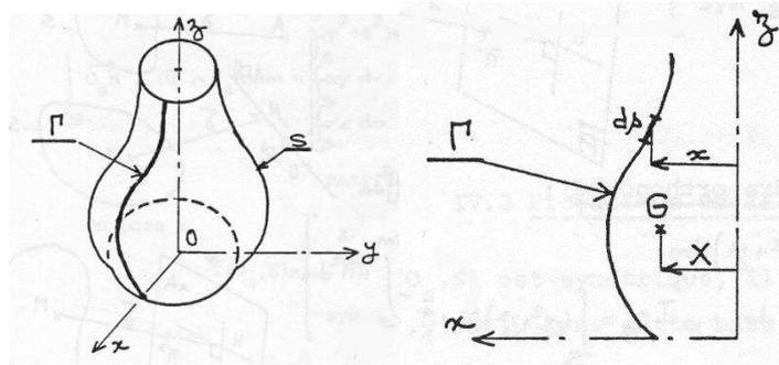
On appelle  $X$  les coordonnées du centre d'inertie de la courbe plane  $\Gamma$  dans le plan  $(O, x, z)$ .
