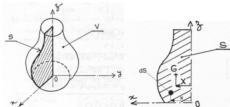
On appelle  $X$  les coordonnées du centre d'inertie de la surface plane  $S$  dans le plan  $(O, x, z)$ .
