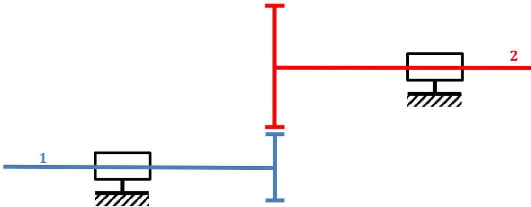
Prenons l'exemple d'un réducteur composé de deux arbres 1 et 2 en liaison pivot avec le bâti de rapport de réduction  $k = \frac{\omega_2}{\omega_1}$
