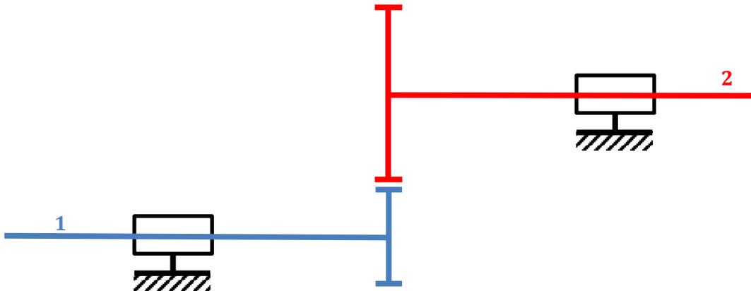
Pour déterminer la loi de mouvement de l'un des arbres, on détermine l'inertie équivalente de l'ensemble ramenée à l'arbre étudié puis on détermine sa loi de mouvement en appliquant le TEC. On peut alors en plus obtenir la loi de mouvement de l'autre arbre avec le rapport de réduction.
