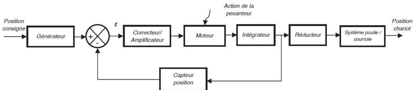
Le capteur de position a un gain  $K_{cap}$ , le réducteur à un rapport de réduction  $\lambda$ , le système poulie courroie a un rayon  $R$  et le générateur à un gain  $K_G$ .
