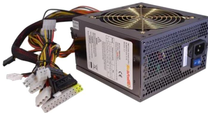
L'alimentation fournit la puissance nécessaire au fonctionnement de tous les composants de l'ordinateur. Branchée au secteur (220V), elle adapte la tension du réseau en différentes tensions adaptées à chaque sous système. De l'alimentation partent un grand nombre de fils avec des connectiques diverses, adaptées à chaque sous système.
