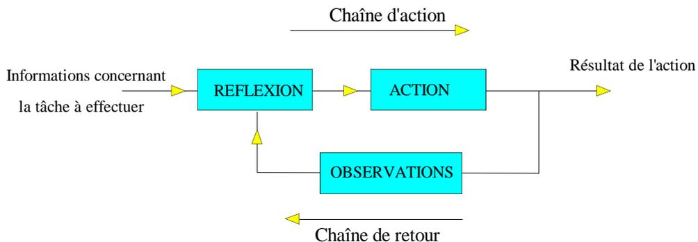
Le système asservi peut être modélisé par le schéma fonctionnel suivant (appelé schéma fonctionnel) :
