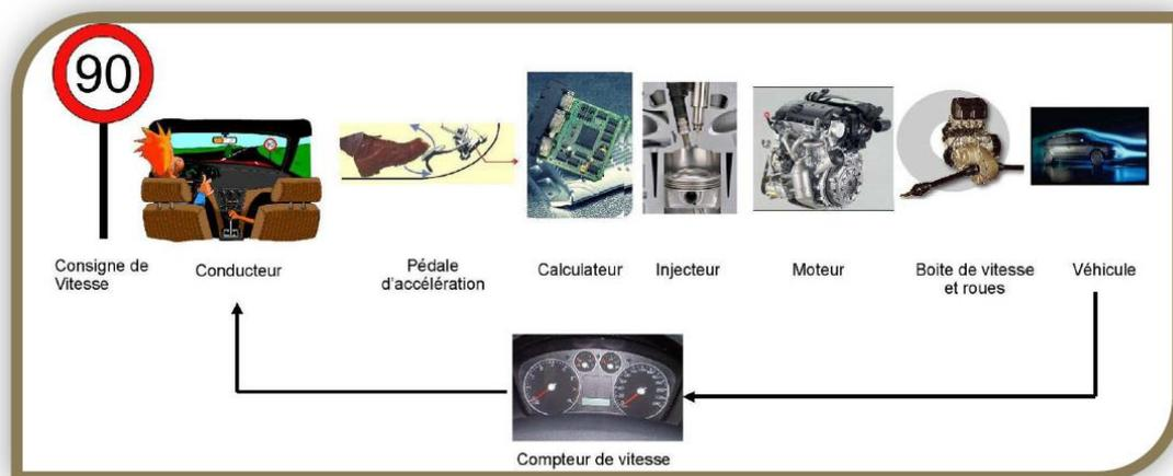
En réalité, l'ordinateur de bord compare la vitesse mesurée sur le véhicule (tension image de la vitesse) et affichée sur le compteur à la valeur demandée par le conducteur (tension correspondant à la valeur demandée) et pilote le moteur en utilisant la différence de tension qu'il modifie et injecte dans la commande du moteur afin d'atteindre cette vitesse.
