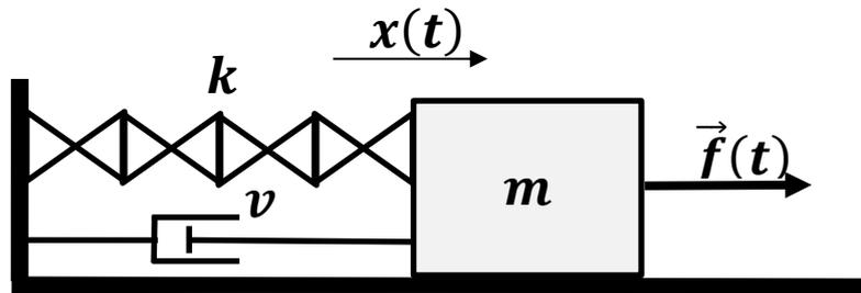
On s'intéresse au mouvement  $x(t)$  de la masse au cours du temps. On souhaite déterminer  $k$ ,  $m$  et  $v$  à partir de la réponse du système sachant que l'on peut faire varier la masse  $m$ .
