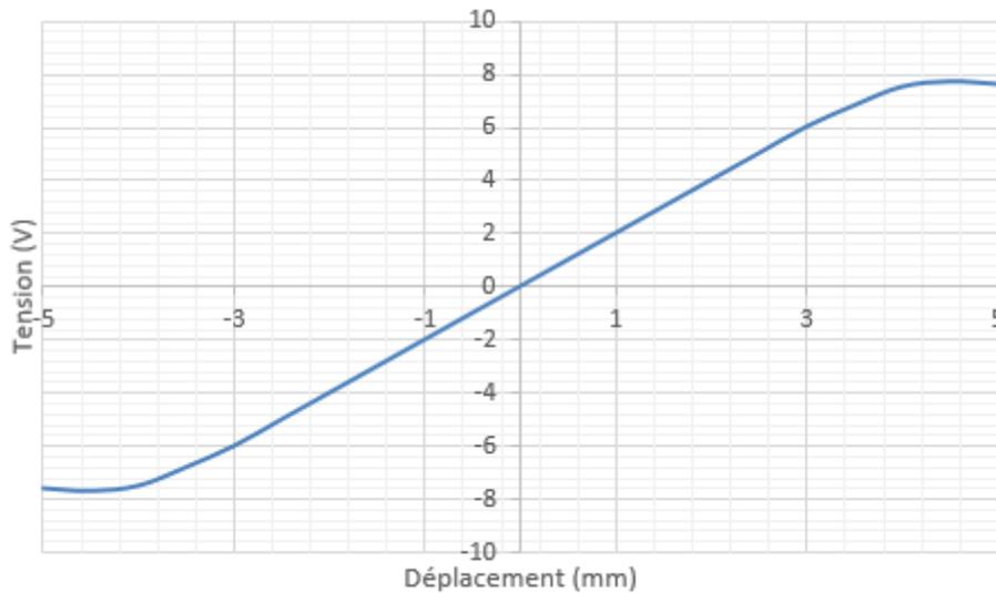
Si les déplacements mesurés restent dans la plage de variation  $[-3; 3]$  mm, la fonction de transfert du capteur peut être assimilée à un gain  $K$  pur tel que
