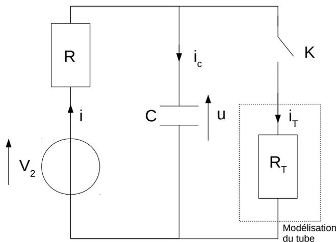
FIGURE 2 – Modélisation du flash électronique
