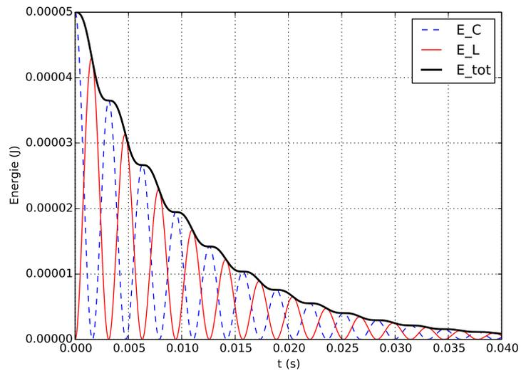
FIGURE 4 – Evolution de l'énergie du circuit RLC
