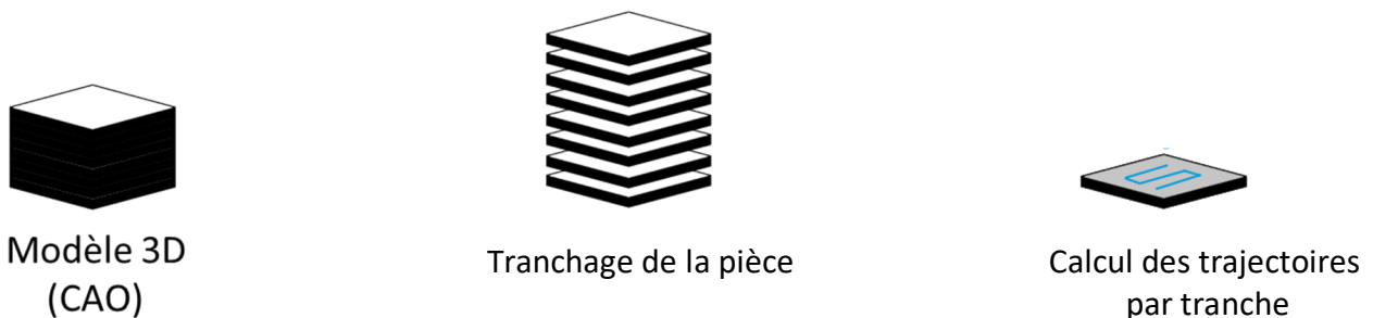
Figure 2 : processus numérique en amont de la fabrication
