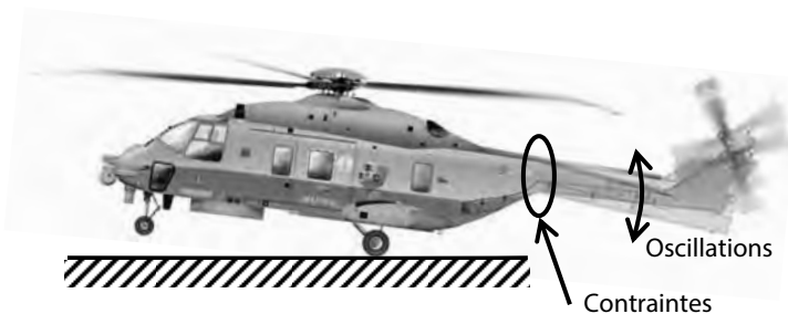
Figure 7 – Premier mode de flexion du pylône de queue situé dans les basses fréquences. (© : Ugo Crisponi)
