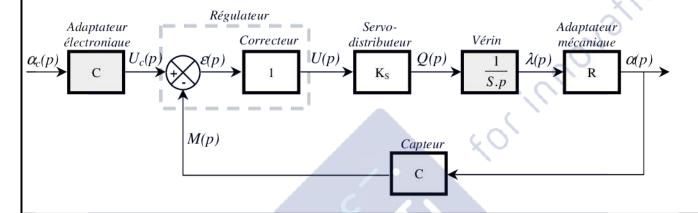
Déterminer la fonction de transfert en boucle fermée du système bouclé FTBF1(p) en précisant les Q.22. expressions de K1 et de \tau1. A partir du critère de temps de réponse à 5 pourcent (tr5%) du système, déterminer la valeur minimale du gain du servo-distributeur.
