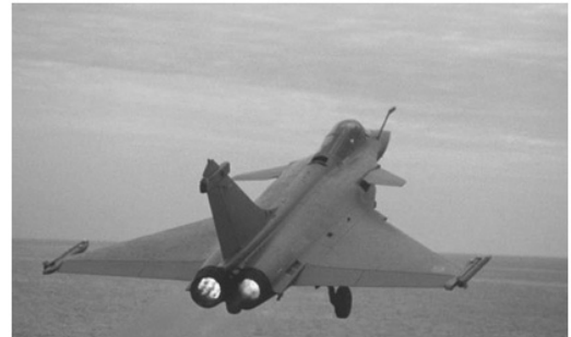
Avion de combat Rafale propulsé par deux moteurs Snecma M88
