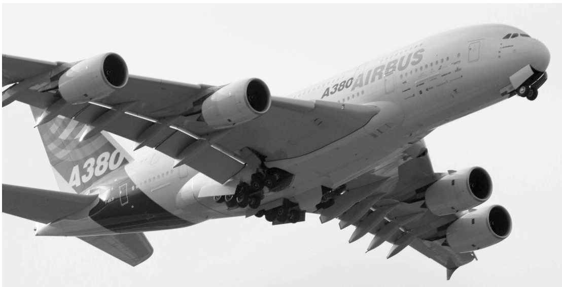
Figure 3 : sortie des trains d'atterrissage sur l'A380
