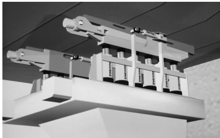
Figure 2 : Vue d'un pousseur de tablier sur une pile en béton
