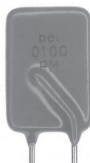
FIGURE 1 – Un type de fusible auto-réarmable ( Bel Fuse, Inc. – 120V 1A) : 20,1 \times 11,5 \times 4,1 \text{ mm}^3 (épaisseur, hors du plan de la figure).
