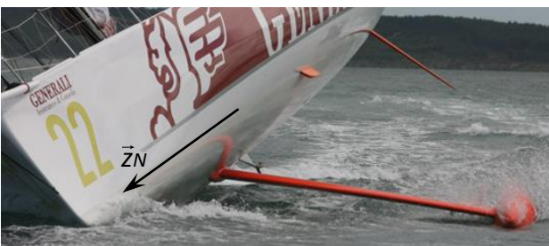
Figure 7 : Voilier avec sa quille pendulaire écartée au maximum sur « bâbord »
