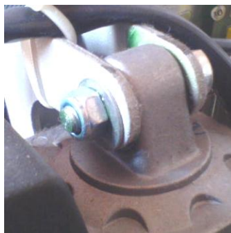
Photo 10 : liaison pivot S_0-S_1
