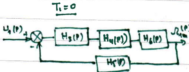
$$A(P) = \frac{H_3 \cdot H_4 \cdot H_5}{1 + H_3 \cdot H_4 \cdot H_5 \cdot H_6}$$
