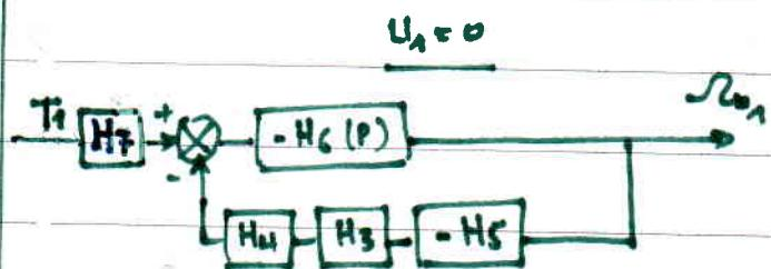
$$B(P) = \frac{-H_6 \cdot H_7}{1 + H_3 \cdot H_4 \cdot H_5 \cdot H_6}$$
