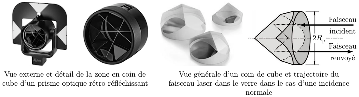
Figure 5 Prisme optique rétro-réfléchissant : photographie et principe du renvoi du faisceau laser
