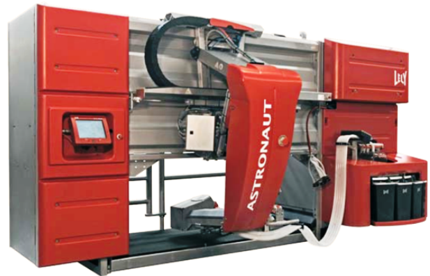
Figure 1 Le robot de traite LELY Astronaut A3 (d'après plaquette LELY) ; le box présenté figure 2 se trouve à l'arrière
