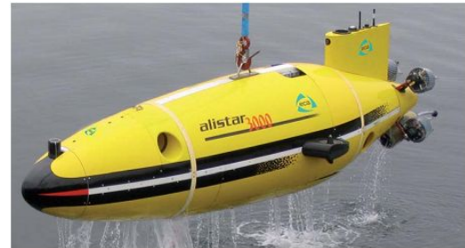
Figure 1 Le sous-marin autonome d'inspection ALISTAR
