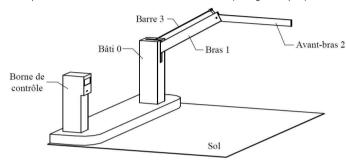
On se propose de déterminer le couple moteur à fournir pour mouvoir ce type de barrière puis de le comparer à une barrière classique.
