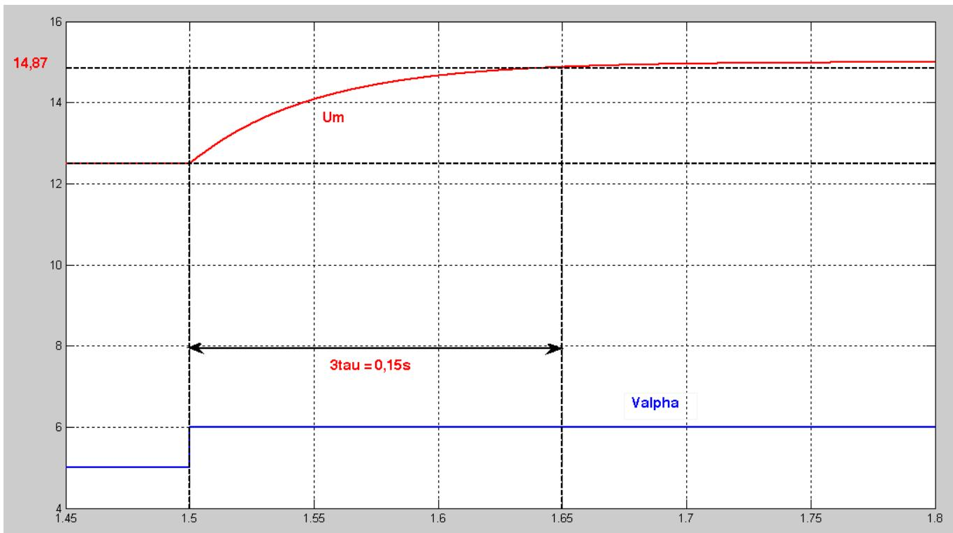
On obtient une variation de  $2,5\text{ V}$  pour la tension  $U_m$ .
