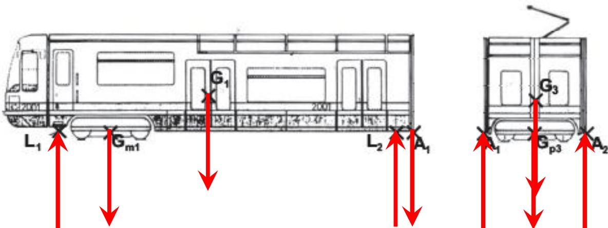
Isolement de la voiture 3 :  $F_{A1} + F_{A2} = P_{B3} + P_{V3}$        $F_{A1} = F_{A2} = \frac{P_{B3} + P_{V3}}{2}$
