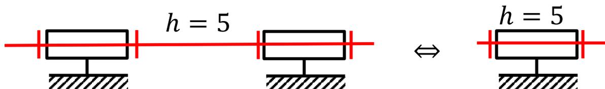
Le degré d'hyperstatisme du système contenant des liaisons équivalentes sera inférieur au degré d'hyperstatisme du système contenant toutes les liaisons. L'écart sera égal à la somme des degrés d'hyperstatisme de chaque liaison équivalente étudiée.
