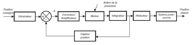
Le capteur de position a un gain  $K_{\text{cap.}}$ , le réducteur à un rapport de réduction  $\lambda$ , le système poulie courroie a un rayon R et le générateur à un gain  $K_{\text{G.}}$
