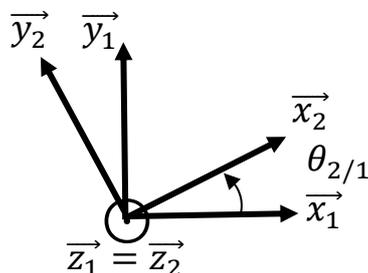
Si l'on demande les coordonnées des vecteurs de la base 2 dans la base 1, personne ne fait d'erreurs avec ce schéma :
