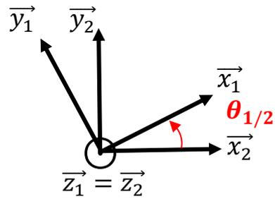
En effet, les bases pouvant être dans n'importe quelle position l'une par rapport à l'autre au cours du temps, cette représentation n'est pas fautive, et sera plus simple à utiliser par la suite pour calculer des projections justes.
