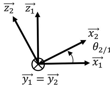
La rotation proposée sur ce schéma est en sens direct visuellement, mais en réalité elle est en sens indirect autour de  $\vec{y}_1$  et  $\vec{y}_2$ .
