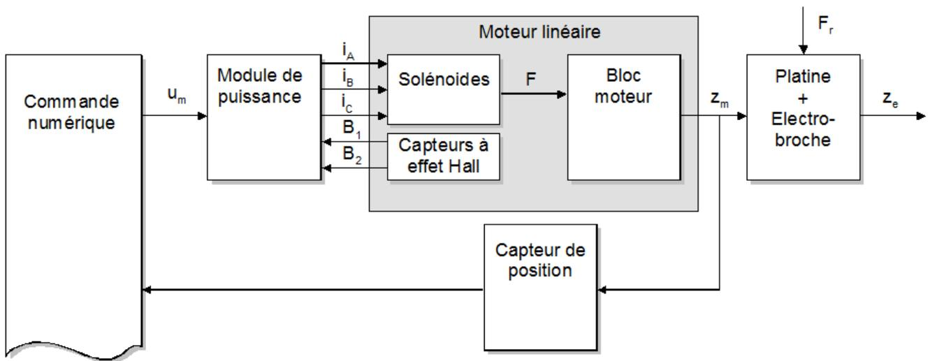
La commande numérique délivre un signal de commande  $u_m(t)$  en volts. L'intensité  $i(t)$  générée par le module de puissance est donnée par l'expression :  $i(t) = K_e \cdot u_m(t)$
